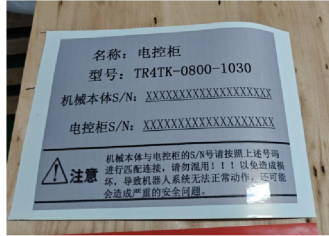
电控柜标贴-灰色贴识（示例）
